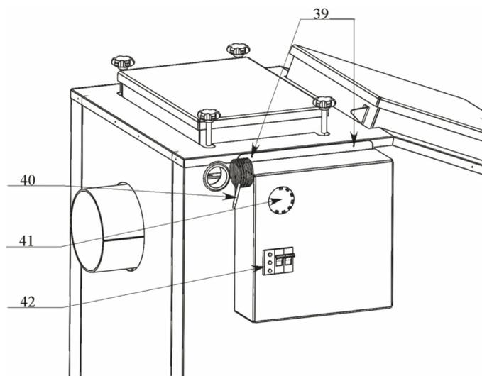
Изменяя положение регулятора t1 на реле времени 42, вы можете менять частоту работы прочистки колосников от 10 до 100 минут с шагом в 10 минут (для нормальной работы автоматической очистки мы не рекомендуем устанавливать частоту очистки менее 50 минут).
